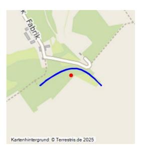
Anschlussgleis zur Fabrik Roda; 1913–1931; Werksanschluss mit Normalspur an die Eisenbahnstrecke Zeitz-Camburg; für Gütertransport von und zur Schwelerei Groitzschen; Gleise abgebaut, Damm erhalten.
