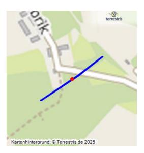
Kohlebahn von der Grube Waldau I zur Verladung am Bahnhof Waldau; 1897–um 1915; Schmalspurbahn; auf erhöhtem Damm; Überbrückung des Baches und der Bahnhofsstraße, Betonstützmauer für Verladerampe und Brücke; Brückenkonstruktion abgetragen.
