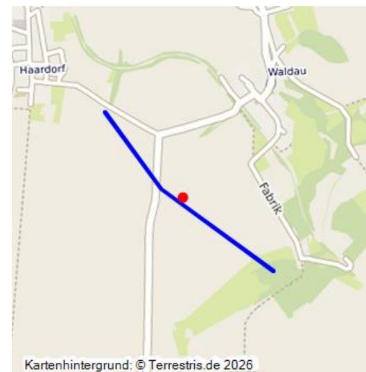
Seilbahn zwischen Grube Waldau II und Waldau I; um 1890; Luftseilbahn verband Grube Waldau II und Grube 383 für Kohletransport in die Fabrik Waldau I; Masten abgebaut, keine Spuren im Gelände sichtbar; Ackerland.
