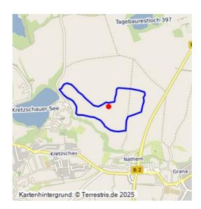
Tagebau der Grube Groitzschen Ost; 1918–1930; Grube der Waldauer Braunkohlen-Industrie AG, belieferte die Fabrik Groitzschen, dabei Schacht und Tagesanlagen der Tiefbaugrube Groitzschen überbaut; mit Innenkippe verfüllt, Tagebaurestloch später mit Abraum aus Aufschluss des Grubenfeldes II (West) nivelliert, rekultiviert, als Ackerland und Forst.
