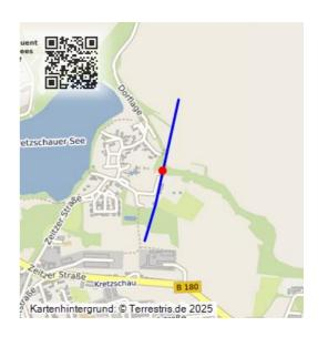
Seilbahn von der Grube Groitzschen zur Fabrik Groitzschen; 1891-um 1918; Seilbahntrasse von 800 m Länge; Masten abgebaut, Areal vielfältig überformt, keine Spuren im Gelände sichtbar.
