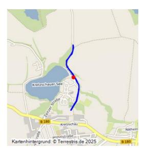
Eisenbahndamm über die Thierbach-Aue; 1936–1963; Strecke einer Kohlebahn, 900 mm, vom Tagebau Streckau zur Fabrik Groitzschen; erhöhter Damm und betonierte Stützwände, Brücke über den Thierbach; Gleise abgebaut, Damm teilweise Abgetragen und überformt; abschnittsweise Nachnutzung der Trasse als gepflasterter Fahrweg.
