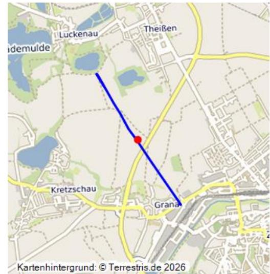
Seilbahn von der Grube Neue Sorge II nach Zeitz-Grana; 1881–1952; nahezu geradlinige Seilbahntrasse von 3750 m Länge; verbindet die zwei Förderschächte Neue Sorge I und II mit Nasspresse und Bahn-Verladestation bei Zeitz-Grana, Kohleübergabe an Zuckerfabrik, ab 1889 zudem Brikettfabrik Herrmannschacht; Masten abgebaut, Ackerboden stellenweise mit Kohlestaub und Metallteilen kontaminiert.
