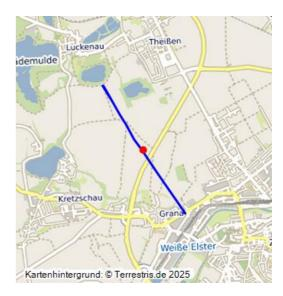
Seilbahn von der Grube Neue Sorge II nach Zeitz-Grana; 1881–1952; nahezu geradlinige Seilbahntrasse von 3750 m Länge; verbindet die zwei Förderschächte Neue Sorge I und II mit Nasspresse und Bahn-Verladestation bei Zeitz-Grana, Kohleübergabe an Zuckerfabrik, ab 1889 zudem Brikettfabrik Herrmannschacht; Masten abgebaut, Ackerboden stellenweise mit Kohlestaub und Metallteilen kontaminiert.
