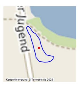
Kippe mit Abraum des Tagebaus Grube Groitzschen; 1940; Abraummaterial aus Erschließungsarbeiten für Tagebau, als Hügel innerhalb einer Weidefläche sichtbar.
