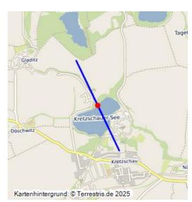
Seilbahn von Grube Hermann Schaede zur Fabrik Groitzschen; um 1890–ca. 1925; Seilbahntrasse von 2750 m Länge, zur Belieferung der Brikettfabrik und Schwelerei Groitzschen (44000267); Masten abgebaut; Areal vielfältig überformt; der nördliche Abschnitt durch Tagebau überbaggert; südlicher Abschnitt mit Erhalt von Fundamentresten an bewaldeter Böschung, an zwei Stellen Beton mit Eisenbolzen, sonst Ackerland.
