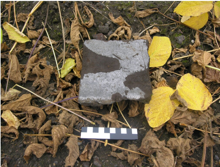
Schacht, Tagesanlagen und Fabrik der Grube Karl Oskar - Oberflächenfund im Fabrikgelände, Schamottestein, glasierte Innenseite ; Maßstab: dl-by-de/2,0 cm Fotograf/Urheber: NAME FEHLT
