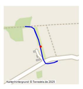
Kohlebahn der Grube Werschen zur Verladestation; 1900–ca. 1915; die Trasse einer schmalspurigen Bahn führte bergab zu Verladung an der Strecke Deuben–Großkorbetha (1897); vom Damm keine sichtbare Spuren im Gelände, hingegen Verladestation mit Nebengleis als Damm erkennbar, mit Gras und Obstbäumen bewachsen.
