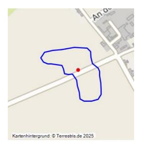
Bruchfeld der Grube 338; 1872–1893; Gelände mit Setzungserscheinungen; Niveauunterschied besonders gegenüber der auf Sicherheitspfeiler liegenden Straße Aupitz–Fabrik Webau bemerkbar; Ackerland.
