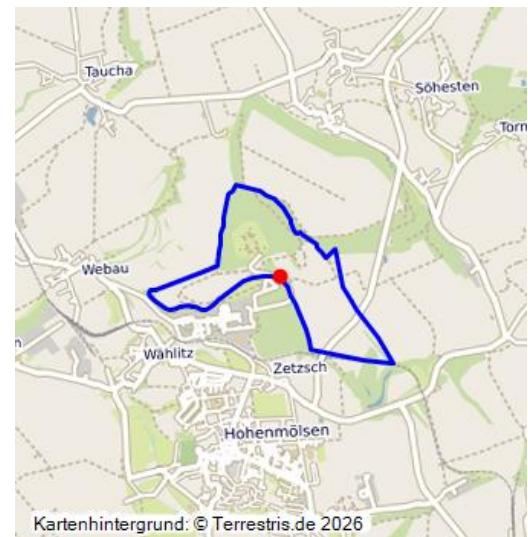
Kippe des Tagebaus Grube Wählitz; 1915–1920; Außenkippe mit Abraum aus Tagebauaufschluss der Grube Wählitz I, auf einer Fläche von ca. 1800 x 1000m; dabei ältere Gruben und Bruchfelder überdeckt (z.B. Grube Friedrich 1873–1914); mit ca. 35 m hoher Kippenböschung an der Nordwestflanke; rekultiviert als Ackerland, z.T. aufgeforstet, Wiesenflächen mit Windkraftanlage, zwischenzeitlich als militärischer Übungsplatz genutzt.
