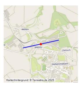
Seilbahn von Grube Neu Zetzsch zur Fabrik Wählitz; 1904–1928; Trassenführung über Steckelsberg, 3300 m Länge; Masten abgebaut, Gelände durch Bahntrasse und Bebauung überformt, Nachnutzung eines Teilabschnittes als Trasse einer Stromleitung.
