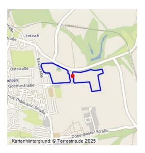
Bruchfeld der Grube Neu Zetzsch; vor 1904–1928; Tiefbaugrube der Werschen-Weißenfelser Braunkohlen AG; Gelände mit Setzungserscheinungen; westlich anschließender Weg auf einem Sicherheitspfeiler; Restbereiche unter Ackerland erhalten, sonst durch Tagebau Wählitz I weitgehend überbaggert.
