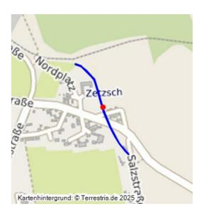
Kohlebahn von Profen-Bösau zur Fabrik Wählitz; ca. 1930-um 1970; Schmalspur (900 mm), Damm und Fundamente eines Brückenbauwerkes über eine Straße; nach Aufschluss Tagebau Wählitz I (1905–1942) Streckenverlegung nach Süden; Damm streckenweise erhalten, u. a. in Gartengrundstücke integriert; sonst abgetragen und überbaut.
