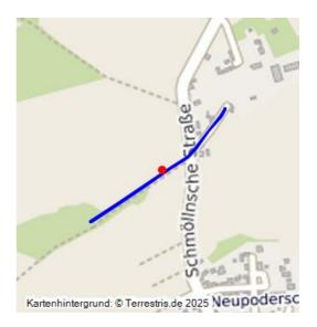
Kohlebahn von Grube 526 Hammerschacht zur Grube Kiefernschacht; 1867-1918; eine Pferdebahn verband die beiden Gruben, Kohletransport vom Hammerschacht zur Fabrik Grube Kiefernschacht bei Neupoderschau (Thüringen), Streckenverlauf identisch mit der heutigen Straße; abschnittsweise bis zu 2 m erhöhter Damm, für ein gleichmäßiges Steigungsprofil; Gleise entnommen, Damm als unbefestigter Fahrweg in Nutzung.
