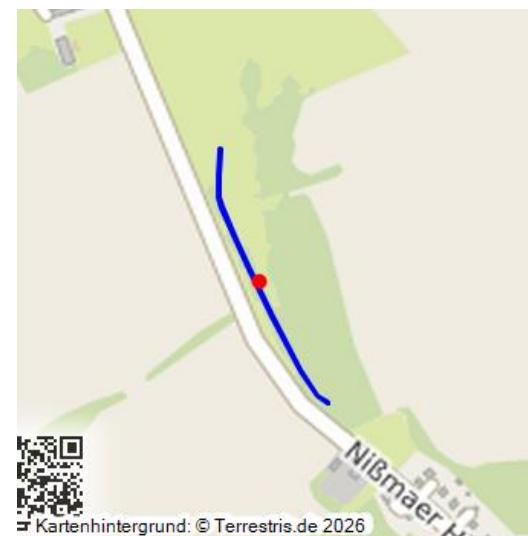
Verlegung und Kanalisierung des Baches; um 1850; wassertechnische Anlage für den Betrieb der Gruben 47–55; künstlicher Bachlauf, auf etwas höherem Niveau, an der westlichen Talseite; Wiesenland mit Baumreihe.
