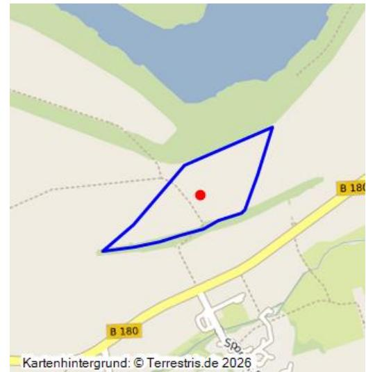
Außenkippe des Großtagebaus Zipsendorf-Süd; 1947–1964; zuvor Grube Leonhard I; Abraum aus Erschließungsarbeiten für Großtagebau Zipsendorf-Süd; dadurch die Straße Wultz–Spora in ihrem Verlauf modifiziert, mit einer Doppelkurve zur Überwindung der Böschung; rekultiviert als Ackerland, Böschung mit Aufforstung.
