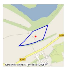
Außenkippe des Großtagebaus Zipsendorf-Süd; 1947–1964; zuvor Grube Leonhard I; Abraum aus Erschließungsarbeiten für Großtagebau Zipsendorf-Süd; dadurch die Straße Wuitz–Spora in ihrem Verlauf modifiziert, mit einer Doppelkurve zur Überwindung der Böschung; rekultiviert als Ackerland, Böschung mit Aufforstung.
