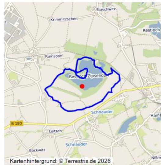
Abbaufeld des Tagebaus Zipsendorf Süd; 1947–1964; Fortführung des 1909 begonnenen Tagebaus Grube Leonhard I, nach Unterbrechung neuerliche Aufschlussarbeiten 1947, Abraummaterial z.T. auf Außenkippe Sabissa verbracht (44000066); Förderung ab 1949, dafür Siedlung Wuitz devastiert; von dem gesamten Abbaufeld etwa drei Viertel der Fläche mit Innenkippe verfüllt, rekultiviert als Ackerland, Teile aufgeforstet; Tagebaurestloch als Gewässer oder Feuchtgebiet (44000039).
