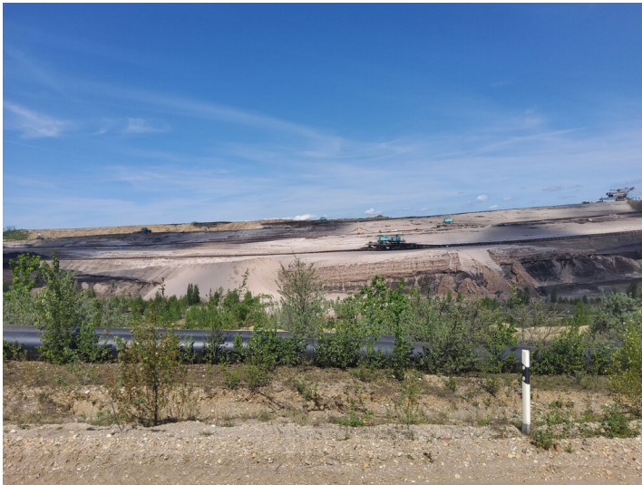
Abbaufeld Profen Süd/D1 (Profen Süd) - zur Zeit wird das Abbaufeld wieder verfüllt und die Böschungen befestigt Fotograf/Urheber: NAME FEHLT
