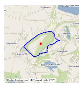
Tagebau Phönix Nord; 1963–1967; Großtagebau der Vereinigung Volkseigener Betriebe Leipzig, Braunkohlenwerk Phönix; Aufschlussarbeiten 1960, bis 1967 ausgekohlt; mit Innenkippe verfüllt, Tagebaurestloch mit Abraum anderer, späterer Tagebaue verfüllt und zusätzlich mit Hochkippe überdeckt (44000009); bis 1989 saniert und rekultiviert; heute Ackerland und Forst.
