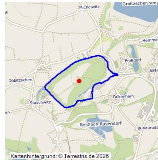
Tagebau Phönix Nord; 1963–1967; Großtagebau der Vereinigung Volkseigener Betriebe Leipzig, Braunkohlenwerk Phönix; Aufschlussarbeiten 1960, bis 1967 ausgekohlt; mit Innenkippe verfüllt, Tagebaurestloch mit Abraum anderer, späterer Tagebaue verfüllt und zusätzlich mit Hochkippe überdeckt (44000009); bis 1989 saniert und rekultiviert; heute Ackerland und Forst.
