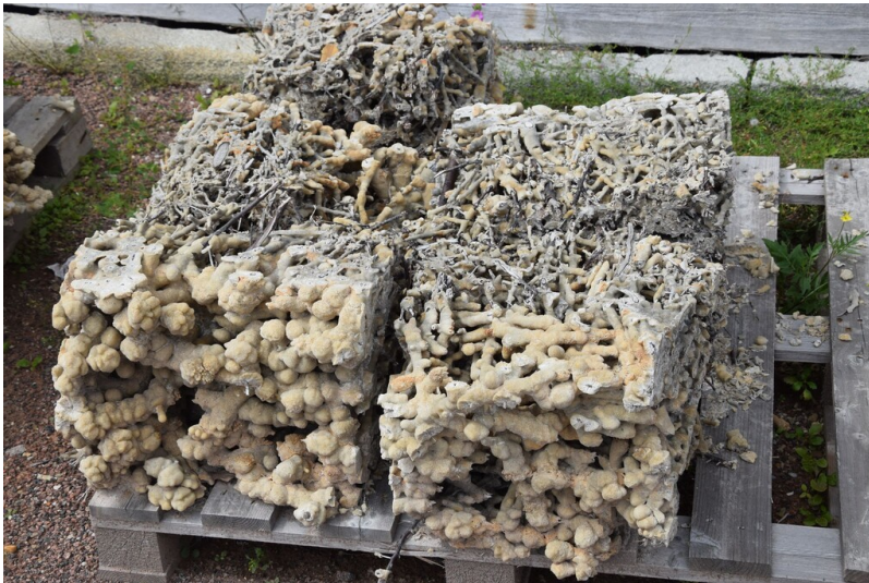
Gradierwerk Bad Dürrenberg - das Schwarzdornreisig der Gradierwerke muss regelmäßig getauscht werden, da schwerlösliche Salze aus der Sole daran auskristallisieren und sog. "Dornstein" bilden Fotograf/Urheber: NAME FEHLT
