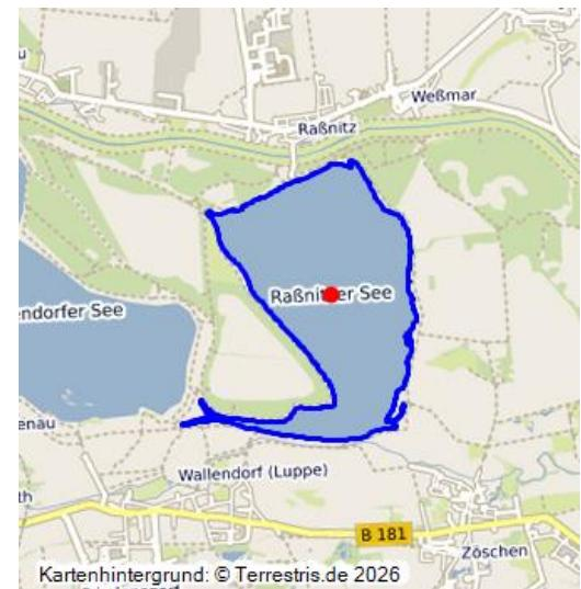
Restsee vom Tagebau Merseburg-Ost (43000118) Baufeld Ib; Tagebaufeldsanierung 1998 abgeschlossen, dabei naturnahe Gestaltung geplant, ergänzend mit Wasser der Weißen Elster geflutet; Wasserpegel durch Überfluss zum Wallendorfer See geregelt; Fläche 307 ha, ca. 66 Mio m³ Wasser; Landschaftsschutzsee, geringe touristische Nutzung, kleines Rad-/Wanderwegnetz, 15m hoher Aussichtsturm.
