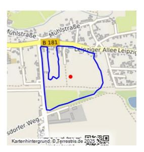
Tagebaugrube der Grube 1 Louise; vor 1851–1871; im Tagebaubetrieb ausgekohlter Bereich; Tagebaukante 1806 und 1851 als Böschungssignatur kartiert, im Tagebau Gebäude dargestellt, vermutlich Werkstätten, Lager und Kohleformerei; Grube mit Abraum verfüllt; südlich vom Ortsteil Pretzsch gelegene Ackerfluren dennoch mit augenfällig abgesenktem Geländeniveau; ein Teil als Friedhof genutzt, sonst Ackerland.
