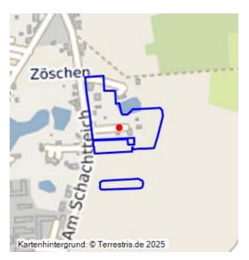
Separates Tiefbauareal der Grube Zöschen; um 1888–1921; im Tiefbau ausgekohlte Bereiche als Bruchfeld, östlich des Weges nach Zscherneddel, Gelände mit Setzungserscheinungen; nachträglich durch Kies- und Tonabbau überformt.
