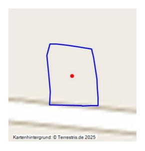
Im Bereich der Straße L187 befinden sich Strecken sowie der Einwirkungsbereich eines Schachtes; laut Risswerk nicht verfüllt; schwaches Geländemerkmal, Abbauteufe 24 bis 30 m.
