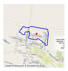
Ehemaliges Abbaufeld im Tief- und Tagebau; in Nutzung 1818 bis 1866; Abbauteufe 10 bis 24 m; zweigeteilt durch die Straße L187, die von mehreren Strecken unterquert wird; insgesamt stehen laut Risswerk noch ca. 232 m Strecke offen, eine 135 m lange Entwässerungsstrecke am Südrand des Tagebaus sowie Lichtloch Nr. 1 und Mundloch.
