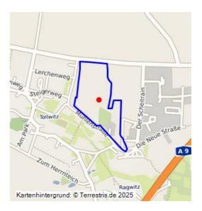
Tiefbaugrube, Im Bereich der L187 befinden sich Strecken sowie der Einwirkungsbereich von zwei Schächten, laut Risswerk nicht verfüllt, schwaches Geländemerkmal.
