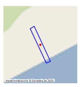
Über das Einlaufbauwerk Stöbnitz mündet das Flüsschen Stöbnitz in den Geiseltalsee; 2003–dato; 370 m lang; das Einlaufbauwerk Stöbnitz beginnt mit einer verrohrten Übergangsstrecke, verläuft dann als Raugerinne in einem großen nach Süden weisenden Bogen über das Böschungssystem und endet im unteren Bereich als S-förmiges Gerinne; etwa 100 m nördlicher als der ursprüngliche Lauf der Stöbnitz; in Nutzung.
