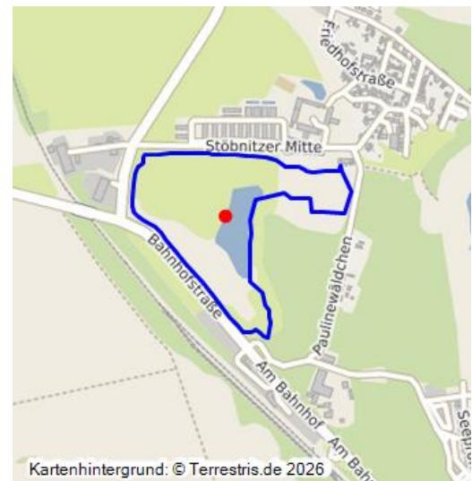
Abbaufeld „Schmirmaer Flügel“ des Tagebaus Mücheln; 1968–1971; Landinanspruchnahme 14,5 ha; kleines und schnell ausgekohltes Abbaufeld westlich der älteren Grube Pauline, stieß südlich an den Ort Stöbnitz, der damit von drei Seiten von Tagebau umgeben war; als Spülkippe fast vollständig mit Abraum wiederverfüllt; heute abschüssiges Feld mit kleinem Teich.
