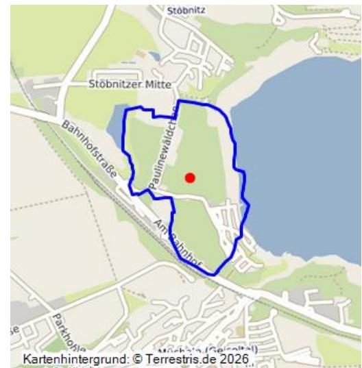
Abbaufeld der Grube Pauline; 1837–1937; Landinanspruchnahme 46,6 ha; erste länger bestehende Grube im Revier; in dieser frühen Phase einzige größere Grube mit regelmäßiger Förderung; Energielieferant für Zuckerfabrik Stöbnitz (ab 1864) und Ziegelei Stöbnitz; schon 1890 Ketten- und Seilbahn; zeitweise Stilllegung mangels Nachfrage aus Leuna; heute verfüllt und mit „Paulinenwäldchen“ bewachsen.
