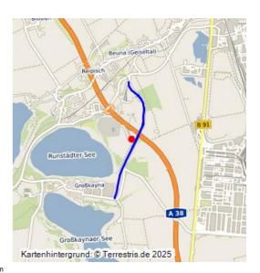
stillgelegte Bahnstrecke Großkayna-Beuna-Leuna; 1907–1972; Normalspur; Transport der Kohlen aus Tagebau Beuna 42000113, Tagebau Kayna-Süd 42000021 und der Brikettfabrik 42000160 in Richtung Industriestandort Leuna 43000057; zunächst nur Seilbahn zwischen Tagebau Beuna 42000113 und Halde Beuna 42000116, ab 1937 wird Seilbahn durch Zugbetrieb ersetzt; Nachnutzung der Trasse als Landstraße (L 181, Großkaynaer Straße).
