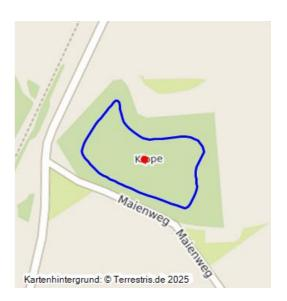
Abraumhalde der Grube Beunaer Kohlenwerke; 1907–1952; 20 ha groß, 35 m hoch (146 m ü. NN), Grundfläche des Haldenkopfes 600 x 450 m, Abraum über Rampe am Nordrand aus der Grube Beuna (42000115) herangebracht, Oberfläche nahezu unverändert: auf dem Haldenplateau etliche Einschläge und Bombentrichter des Bombardements während des Zweiten Weltkriegs ("Schlacht um Leuna") erhalten.
