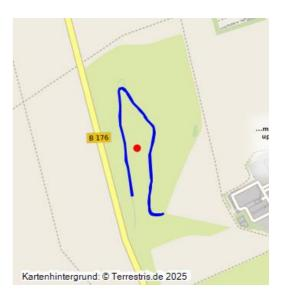
Abzugsgraben auf der Kippe Roßbach-Süd; 1962–1972; vermutlich Wasserabzugsgraben, Ableitung von Niederschlagswasser, zur Vermeidung von Ausspülungen und Hangrutschungen der Kippe; zwei eingegrabene Eisenröhren erhalten, sonst mit Gras bewachsen.
