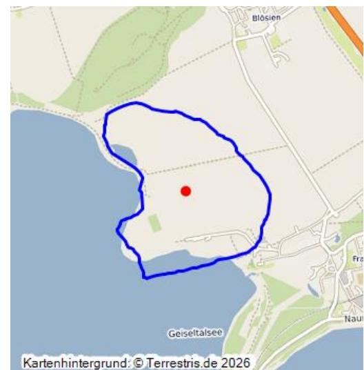
Abbaufeld der Grube Otto Tannenberg (ab 1949 Neumark-Ost); 1927–1955; Landinanspruchnahme 168,8 ha; mit dem Abraum die Halde Blösien (42000068) geschüttet, 1936 Einsatz von I-Phasendrehstromrangierloks zum Bunker Otto Tannenberg; mit Abraum aus Tagebau Geiseltal-Mitte II (42000054) vollständig verkippt.
