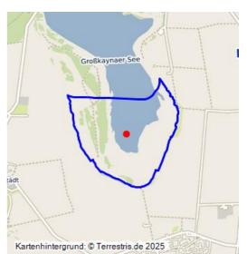
Abbaufeld "Südfeld" des Tagebaus Kayna-Süd; 1959–1965; Landinanspruchnahme 224,5 ha, Tagebau bewegte sich südostwärts, ab 1970 über Spültische mit Abraum aus Tagebau Roßbach verspült, belieferte Brikettfabrik "Gute Hoffnung" Roßbach (40000189), 1996 mit Großkaynaer See (42000025) geflutet; heute Naturschutzgebiet "Bergbaufolgelandschaft Kayna-Süd".
