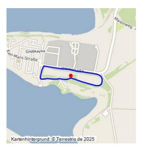
Resthalde Großkayna; 1906–1960er-Jahre; Abraum aus dem Tagebau der Grube Michel-Vesta (42000010), der Grube Rheinland (42000011) und dem Tagebau Kayna-Süd (42000021), 14,5 ha Fläche, 25 m hoch, 1,7 Mio. m³ Abraum; zunächst die westliche Hälfte gekippt, später (um 1930) die östliche Hälfte; nach 1960 wesentliche Kippmassen wieder abgebaggert, daher nur Resthalde; heute bewachsen, schöne Aussicht über den Großkaynaer See.
