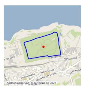
Durch Abraumverkippung aus Tagebau Pfännerhall entstandene Hochhalde; um 1918–1930; 73 ha Fläche, 50 m hoch (162 m ü. NN); trapezförmig, Haldenplateau eben, Böschung steil und regelmäßig, erster Einsatz eines Kleinabsetzer-Systems (Uhilein), im Zweiten Weltkrieg Bunkeranlage angelegt; Oberfläche nahezu original erhalten mit Schüttungsrippen und wenigen Bombentrichtern aus dem Zweiten Weltkrieg ("Schlacht um Leuna").
