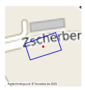
Schacht und Tagesanlage der Grube Gute Friederike; 1841–1861; 1852 mit wenigen Gebäuden kartiert, eine rundliche Grube evtl. als Folge starker Setzung wegen Schwimmsandproblemen in den Schächten; Gebäude abgetragen, Ackerland mit Setzungserscheinungen.
