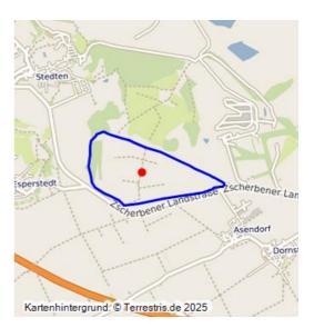
Asendorfer Kippe; um 1940; deltaförmige Schüttung, Abraum aus Tagebau Etzdorf (41000097), Transport durch Abraumbahn; ebene Kippenoberseite, rekultiviert, Ackerland, Böschungen bewaldet.
