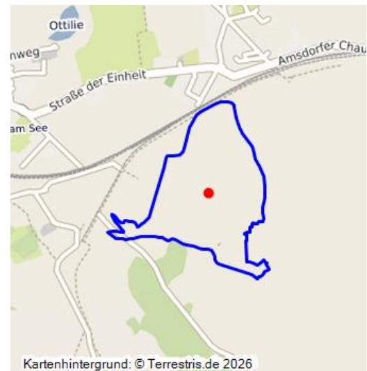
Kippe des Tagebaus Stedten; um 1925; Abraum aus Tagebauaufschluss, über Bruchfeld des Crednerschachtes (41000070) geschüttet; Abraummaterial vermutlich aus Tagebau Stedten, wurde parallel zur Trasse (41000042) per Abraumbahn auf die Kippe gebracht; rekultiviert, zwischenzeitlich Ackerland, jetzt zum großen Teil überbaggert.
