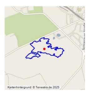
Abbaufeld der Grube Laura; 1847–1901; Förderung im Tiefbau, 1851 durch verstärktes Grubenwasseraufkommen Einrichtung einer Wasserhaltung; Kartierung nach historischem Grubenriss; Flöz 1,5–3 m, Deckgebirge 4–5 m; im südlichen Bereich noch Bruchfeld mit Setzungserscheinungen und Tagesbrüchen sichtbar; heute Ackerland, Weideland, ein Teil von Deponie überdeckt, Tagesbrüche verschliffen, rekultiviert.
