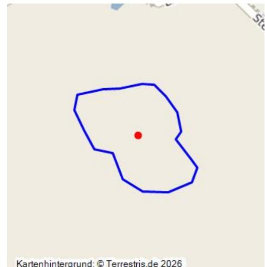
Bruchfeld der Grube Laura; 1847-1890; Tiefbau, Bruchfeld mit Setzungsercheinungen und Tagesbrüchen, im LIDAR erkenntlich; Flöz 1,5-3 m, Deckgebirge 4-5 m; heute Ackerland, Tagesbrüche verschliffen.
