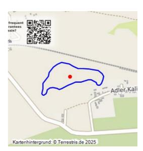
Tagebaurestloch der Grube Wilhelmine; von 1809–1890, Flöz 6 m, Deckschicht 1,5–5 m, Abbaurichtung nach Norden, dabei Ablagerung in den ausgekohlten Bereichen der ersten Tagebauphase (vor 1850) und Bildung der Kippe (41000014); Entwässerung des Tagebaus über einen Röschengraben nach Südost (41000035); Gelände stark überformt, da zusätzlich von Mülldeponie überdeckt, Brachland, feuchte Stellen als Ried.
