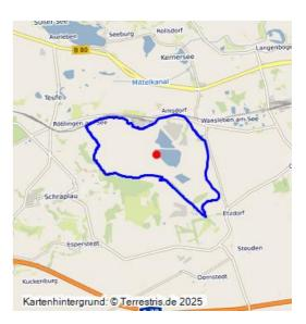
Großtagebau Amsdorf; 1958-heute; gesamtes Abbaufeld auf einer Fläche von etwa 800 ha; Abraum und Kohleförderung ausschließlich mit Bandbetrieb; Aufschlussarbeiten beendet, gegenwärtig Förderung bereits freigelegter Flöze und Verarbeitung in der Montanwachsfabrik ROMONTA GmbH (41000011); Tagebaugrube mit Innenkippe sowie durch Aschespülkippe verfüllt, Tagebaurestloch als zukünftiger See projektiert (41000215).
