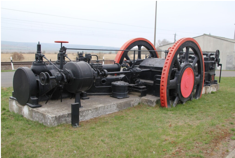
Zwillingspresse der ehemaligen Briketfabrik Stedten - Gesamtansicht Fotograf/Urheber: NAME FEHLT
