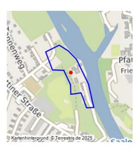
Papierfabrik Kröllwitz (1716–1940); Fabrikanlage zur Papierproduktion, ab ca. 1820 wird für die Feuerung und Kesselhäuser auch Braunkohle eingesetzt; diese kommt überwiegend aus den Gruben bei Nietleben per Kohlebahn, entlang des Weinberges, zu einer Entladestelle an der Saale bei Kröllwitz.
