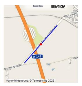
Trasse einer Kohlebahn zum Bahnhof Schlettau; 1875–1906; Damm einer Schmalspurbahn, Pferdebahn; Verlauf parallel und neben der Straße Eisdorf–Zscherben; Kohletransport von Grube Friedrich Wilhelm und Schächten des Pachtfeld II (bis 1913) zu einer Verladestation mit Gleisanschluss Normalspur an die Bahn Halle–Eisleben; Damm durch spätere Straßenverbreiterung überformt.
