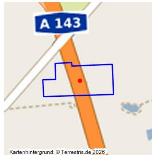
Zwei Schächte im Fiskalischen Pachtfeld II; 1861–1913; Tiefbauschächte mit jeweils einem Gebäude der Tagesanlage; 1872 kartiert, zudem nördlich benachbart 8 kleine Hügel vermutlicher Schachthalden von älteren Schächten mit Handförderung; durch Autobahnbau weitgehend zerstört, sonst Ackerland.
